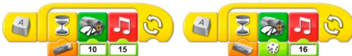
Программа «Спасение самолёта» модифицируется, добавляются различные звуки после каждого Блока «Ждать». Первая программа ожидает, когда самолёт поднимет нос, после чего увеличивает мощность мотора до 10 и воспроизводит Звук 15 (Мотор). Вторая программа ожидает, когда самолёт опустит нос, после чего изменяет мощность мотора в соответствии со случайно выбранным числом в диапазоне от 1 до 10 и воспроизводит Звук 16 (Глухой стук). Затем обе программы повторяются.
