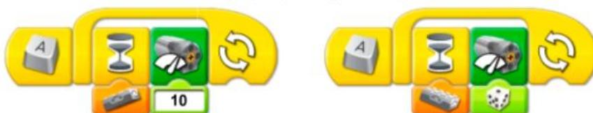
Первая программа ожидает, когда нос самолёта приподнимется, после чего включает мотор при уровне мощности 10. Затем программа повторяется. Вторая программа ожидает, когда нос самолёта опустится, и включает мотор
